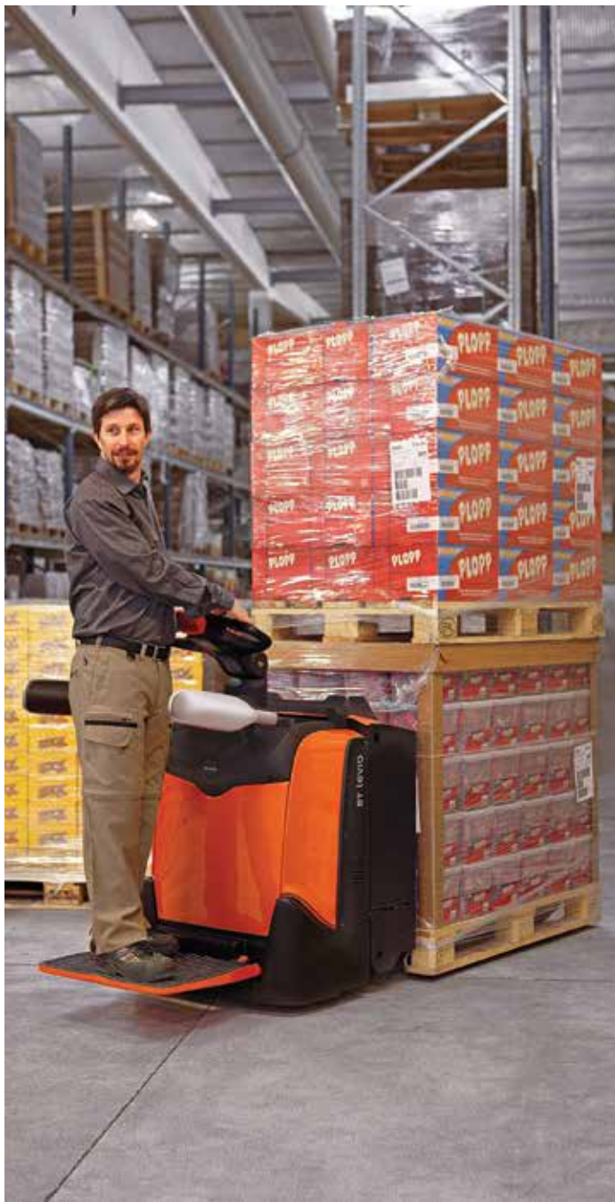
One-touch beweging om de zijbeschermingsbeugels weg te klappen
