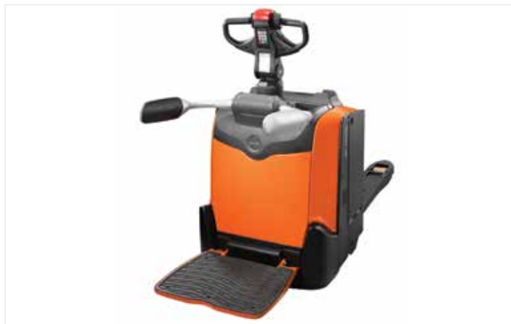
One-touch beweging om de zijbeschermingsbeugels weg te klappen
