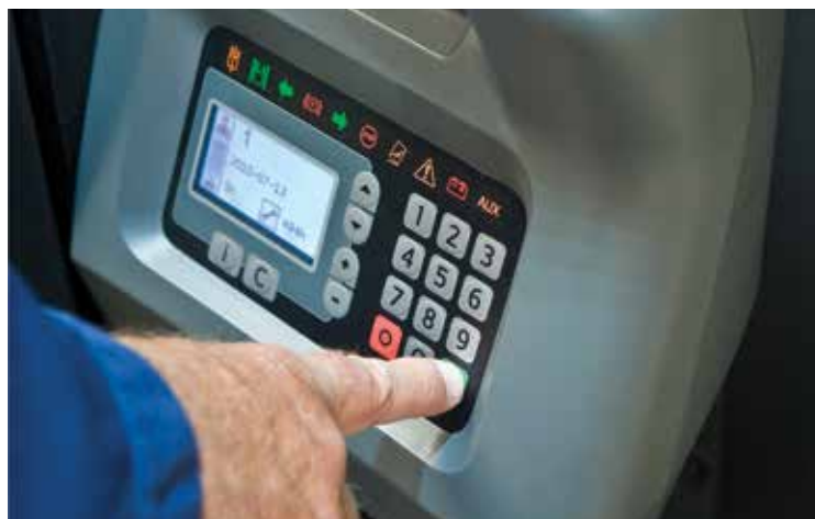
BT toegangscontrole verhindert ongevoegd gebruik en zorgt voor de automatische instelling van de voorkeursparameters bij het starten
