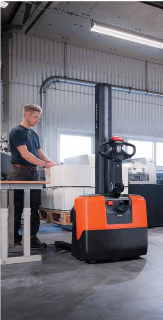
Het HWE100S model kan diverse palletformaten hanteren dankzij de verstelbare breedspoorvorken
